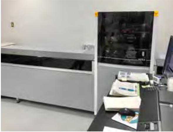
図3 マイクロXRFコアスキャナー
