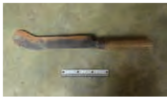
鉈(現地名:ダオ) 切る・割る・削る 刃角:6度 刃部分の重さ:420g
