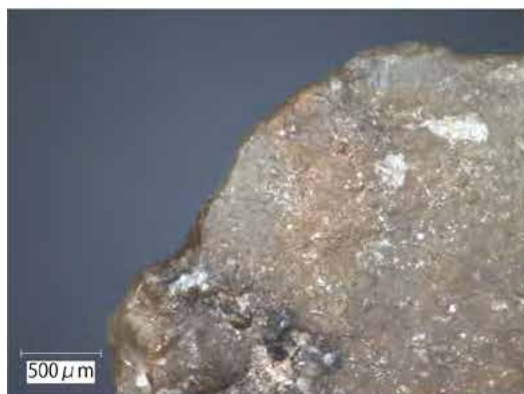
BM2014-083-1×100 先端部腹面の摩耗
