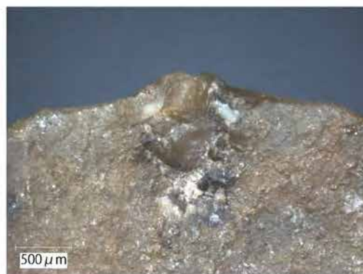
BM2014-083-12×100 先端部腹面突出部右侧（先端側）の摩耗
