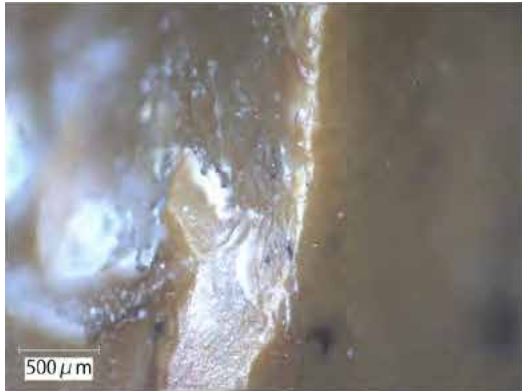
BM2014-341-3×100 先端部背面稜線。上半分（先端側）に摩耗
