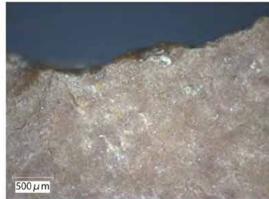
BM2014-020-2×100 左辺腹面側の突出部の摩耗
