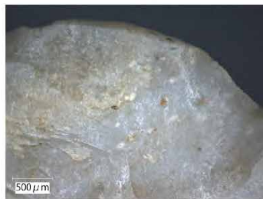
BM2014-055-8×100 下辺腹面の突出部の摩耗
