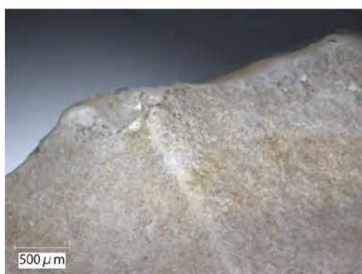
BM2014-055-4×100 上辺腹面の突出部の摩耗
