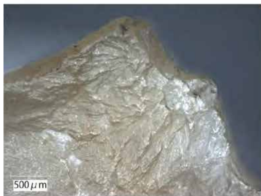
BM2014-045-3×100 中央の先端部腹面。左側に弱い摩耗
