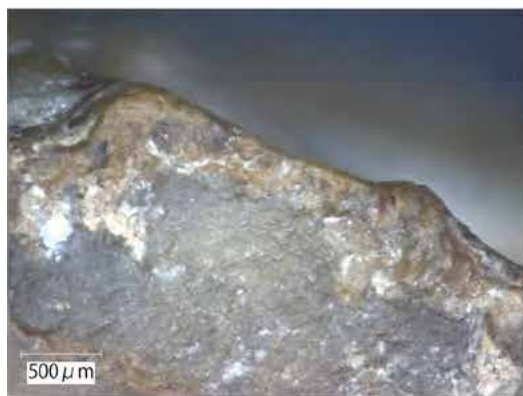
BM2014-208-5×100 対向辺腹面側の突出部の摩耗
