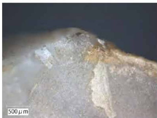
BM2014-055-12×100 上辺背面の突出部の摩耗
