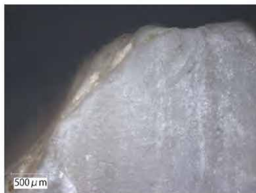
BM2014-087-2×100 先端部左辺背面の摩耗
