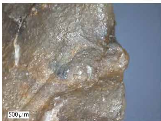
BM2014-083-15×100 先端部背面（12の反対面）の摩耗
