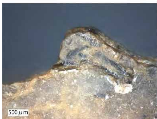
BM2014-208-1×100 先端部腹面の摩耗
