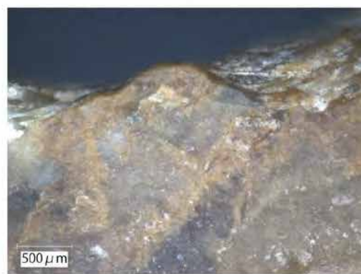
BM2014-208-4×100 対向辺腹面側の突出部の摩耗
